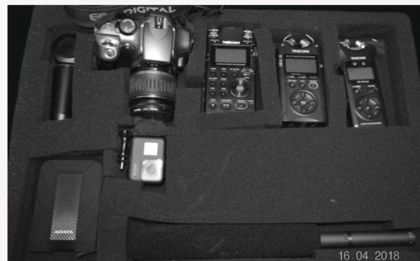
Figura 7. Equipo para entrevistas. De izquierda a derecha: micrófono omni, cámara fotográfica digital, grabadora de audio con Phantom Power, grabadora de audio semi profesional, disco duro en estado sólido, cámara GoPro, micrófono Shotgun. Fotografía: elaboración propia.
